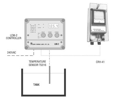
FIG.12 CRH-41 RECORDING TEMPERATURE
